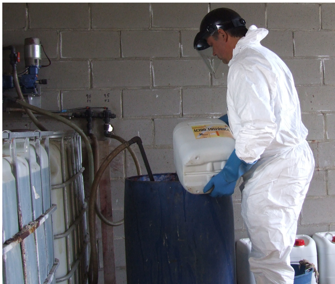
Figura 2. Preparació de la dissolució al tanc de fertilitzants i aplicació de l'àcid a l'aigua (Foto: ECA Tàrrrega).
