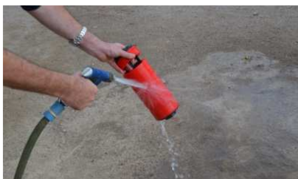
Fotografia 2. Neteja manual d'un filtre d'anelles amb aigua a pressió.
